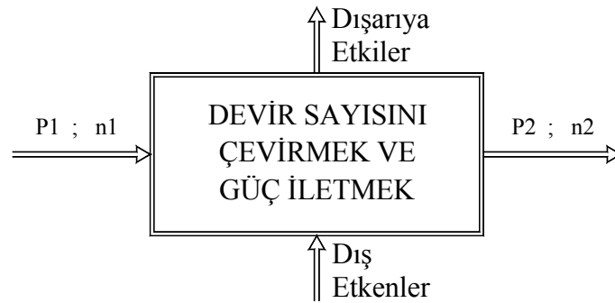
Şekil 2.11, Kaldırma tahriki redüktörünün kaba fonksiyon strüktürü
