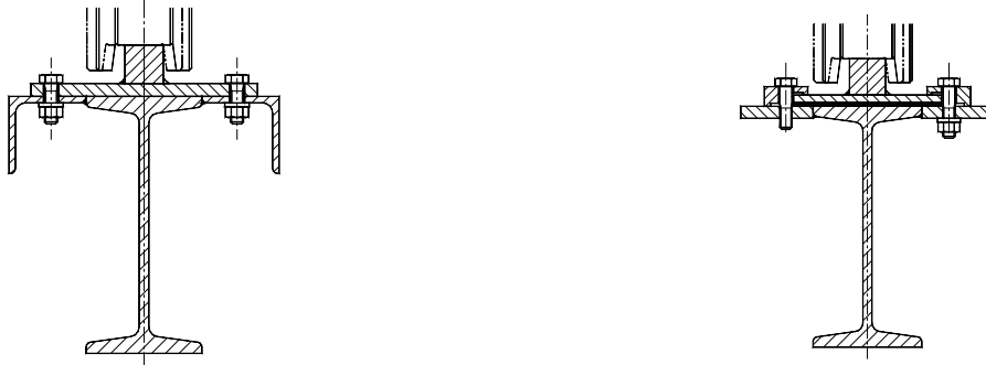
a) Ek lamalı ray, profil üstüne yerleştirme b) Ek lamalı ray ile profil arası elastik parçalı ve pabuçlu Şekil 51, Ek lamalı ray ve çelik konstrüksiyon kirişler
